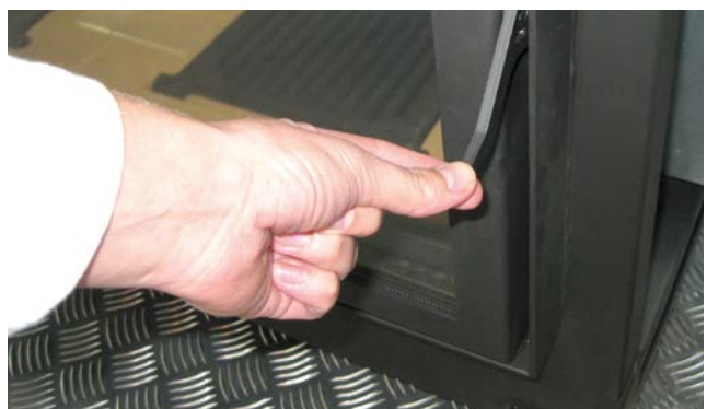
Illustrasjon 18.3 Spakelås, ett punktslås på siden Gjelder for Lina TV, for tilgang til den sekundære døren (svingdør)
