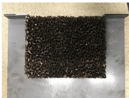
Katalysatoren sett fra røykuttaket over vermikulitt-røykvenderplaten
